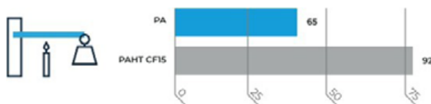
Figura 5: Temperatura de deflexão térmica (1,82 MPa), em °C, do Ultrafuse® PA e Ultrafuse® PAHT CF15. Fonte: BCN3D.
