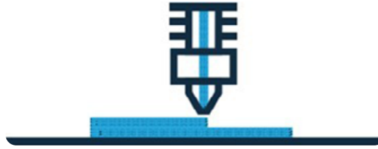
Figura 6: Representação do processo de impressão 3D de materiais compósitos de fibras curtas. As fibras se alinham no sentido da deposição do material fundido.
