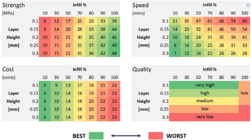
Figura 3 - Impacto das variações da resistência, qualidade, custo e velocidade conforme preenchimento - Fonte: 3DMatter.
