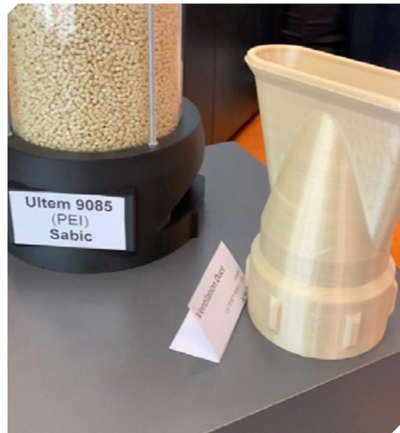
Pellets e peça impressa em Ultem 9085 no stand da AIM 3D.
