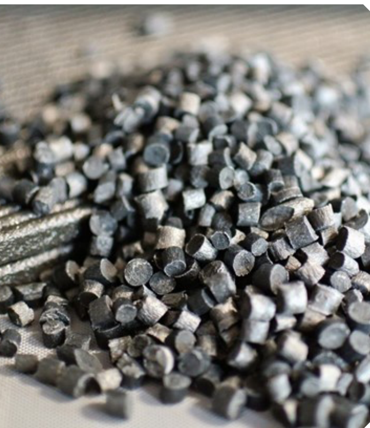
Matéria-prima para FGF: Pellets de ABS reforçado com fibras de carbono. Foto: 3D Systems.
