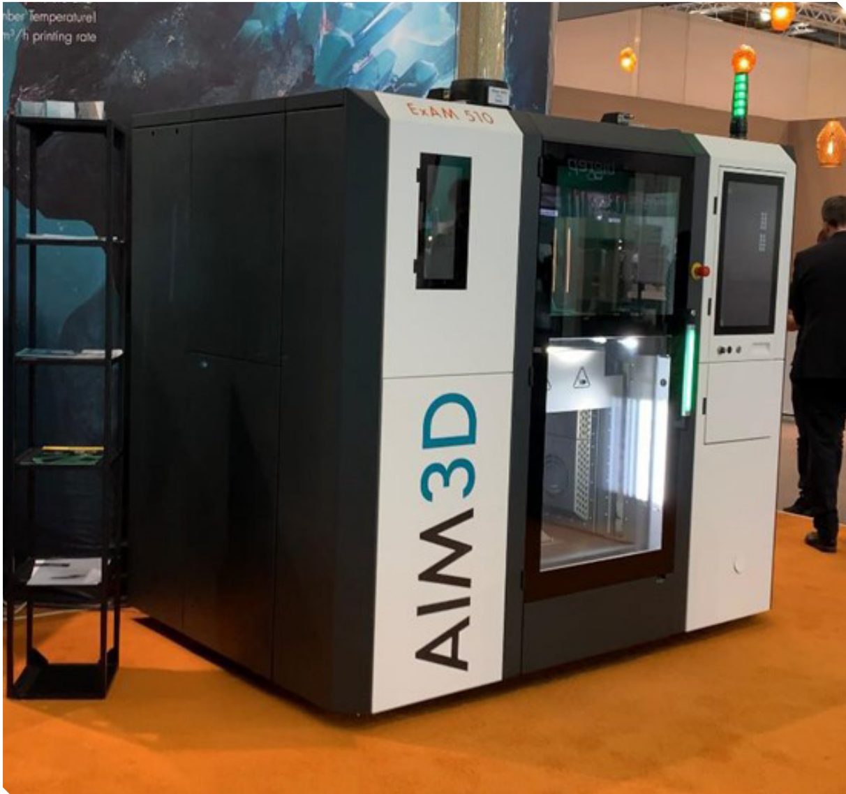
Impressora de pellets ExAM 510, da AIM 3D, com capacidade para processar plásticos de alta performance e compósitos metálicos e cerâmicos.
