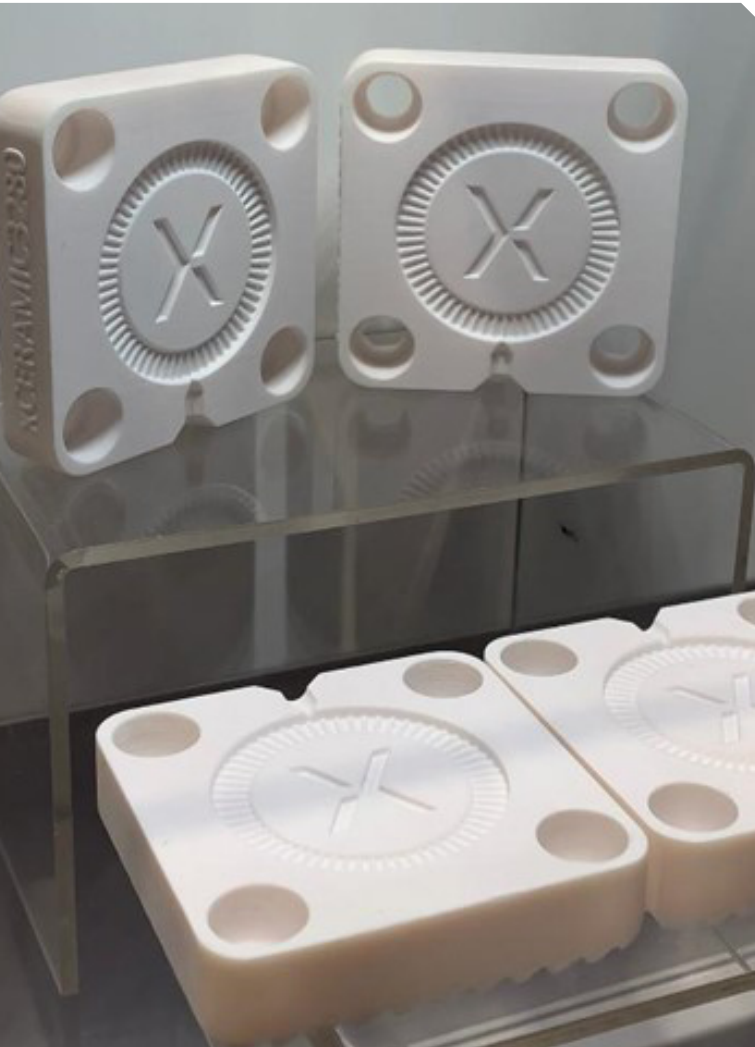
Moldes para injeção fabricados por impressão 3D com a resina BASF Ultracur3D RG 3280 na Nexa3D XiP.
