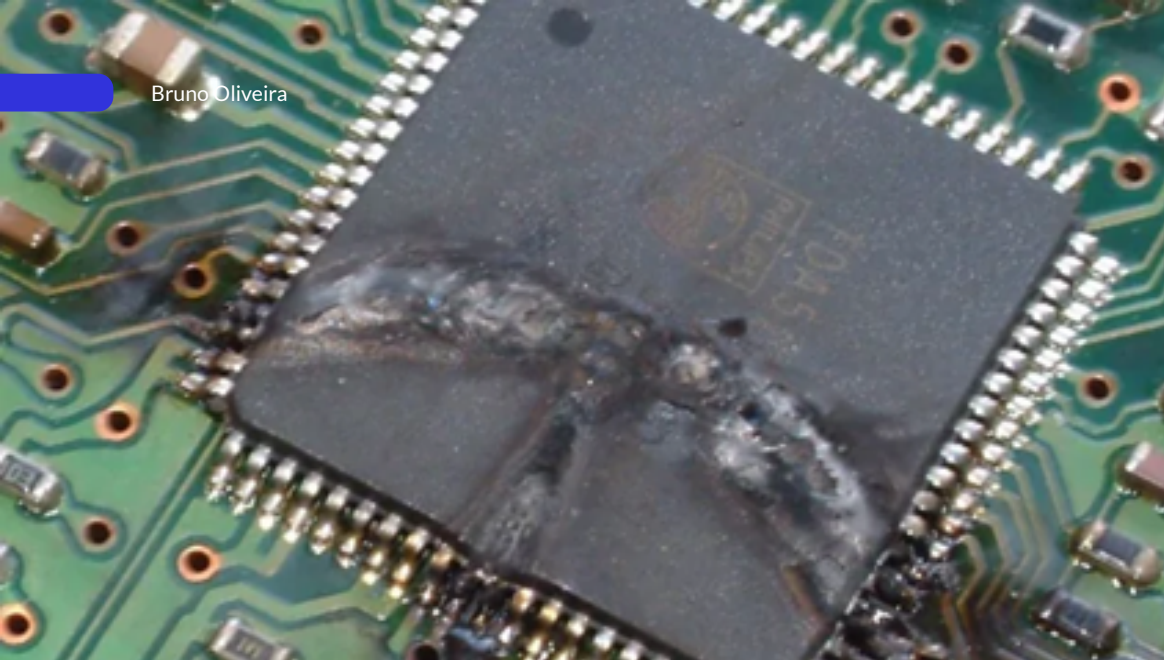
Figura 2: Dispositivo danificado por ESD. Fonte: https://produza.ind.br/tecnologia/descarga-eletrstatica/
