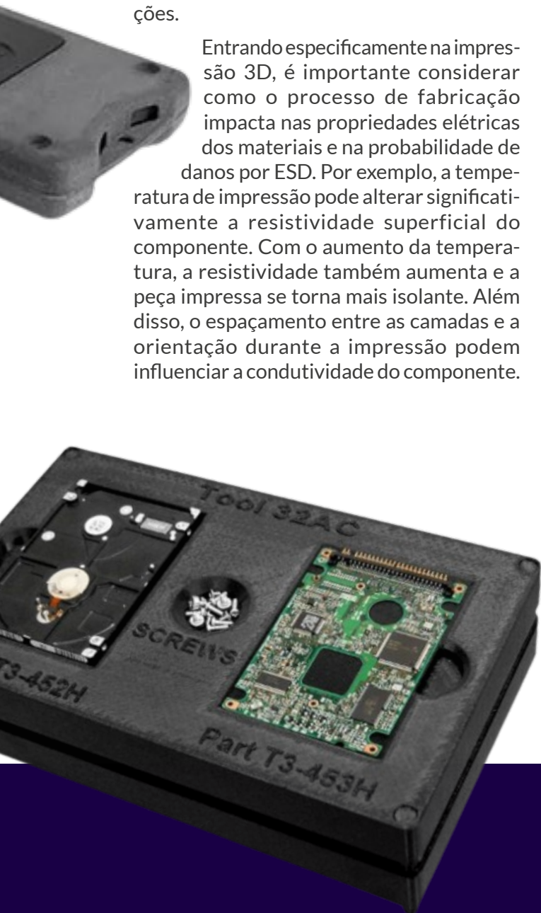
Figura 6: Case de proteção ESD impresso com filamento ABS dissipativo.
