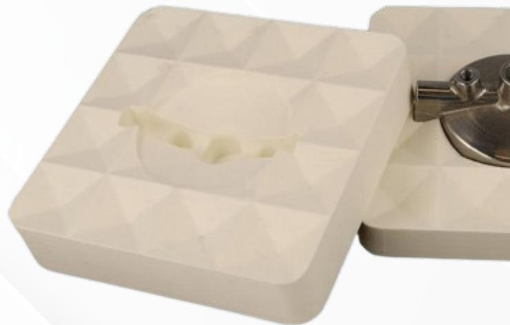
Figura 5: Impressão de case em Ultrafuse TPU 64D.
